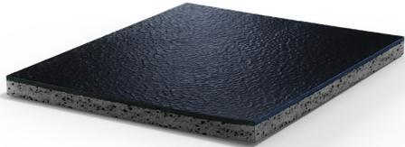
Revêtement sport d'intérieur en caoutchouc naturel et synthétique à haute densité, calandré et vulcanisé, avec une épaisseur constante totale de 10 mm. La couche supérieure est une surface de 2 mm non poreuse, légèrement martelée, opaque, polie, antidérapante et antibactérienne, avec une composition constante, qui à son tour se vulcanise dans une couche inférieure plus flexible et de moindre densité, composée de caoutchouc à haute teneur en matériaux recyclés.
