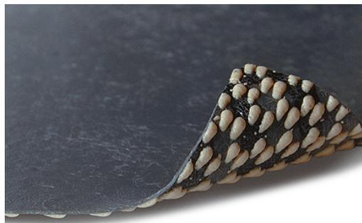
Pavimento deportivo en PVC suministrado en rollos con un espesor total constante de 7 mm. Está compuesto de un estrato de uso prensado, calandrado, con tratamiento de protección superficial, gofrado y en color sólido o imitación madera, un estrato de alta densidad reforzado con fibra de vidrio y un estrato de espuma vinílica espansa de densidad diferenciada.
