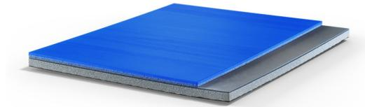
Pavimento prefabricado de caucho natural y sintético, calandrado y vulcanizado en rollos. El estrato superior es una superficie no porosa, lisa, marmolizada, antideslizante y bacteriostática, que a su vez se vulcaniza a un estrato inferior, conformando un espesor total constante de 2,5 mm.
