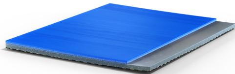
Revêtement sportif calandré et vulcanisé à base de caoutchouc naturel et synthétique, charges minérales, vulcanisantes, stabilisantes et pigments colorants. Constitué d'une couche d'usure à surface lisse apparente opaque, antidérapante, tonalité marbrée, vulcanisé à une sous-couche portante résiliente, formant un matériau unique à épaisseur constante de 2,5mm.
