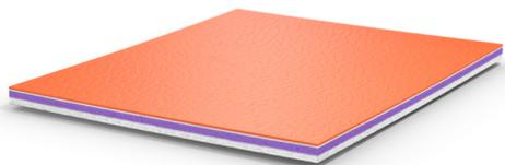
Pavimento deportivo en PVC suministrado en rollos con un espesor total constante de 7 mm. Está compuesto de un estrato de uso prensado, calandrado, con tratamiento de protección superficial, gofrado y en color sólido o imitación madera, un estrato de alta densidad reforzado con fibra de vidrio y un estrato de espuma vinílica espansa de densidad diferenciada.
