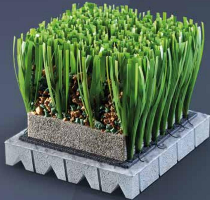
DUAL ANMX EF es un sistema de césped artificial de última generación compuesto por una combinación de monofilamentos 4NX de estructura recta semi-cóncava con 3 nervios asimétricos y filamentos fibrilados Monofeel, relleno técnico Natural Mix® y subbase elástica prefabricada en espuma de polietileno expandido con célula cerrada.
