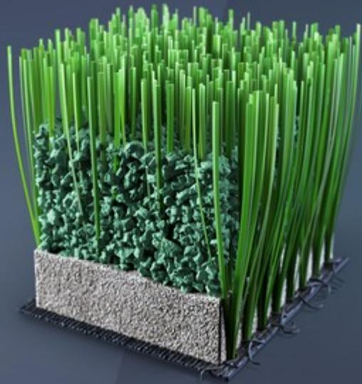
**SISTEMA IN ERBA ARTIFICIALE DI ULTIMA GENERAZIONE COMPOSTO DA MONOFILAMENTI 5NX A STRUTTURA DRITTA SEMICONCAVA CON 3 NERVATURE ASIMMETRICHE E INTASO PRESTAZIONALE IN GRANULI DI SBR NOBILITATO.**
