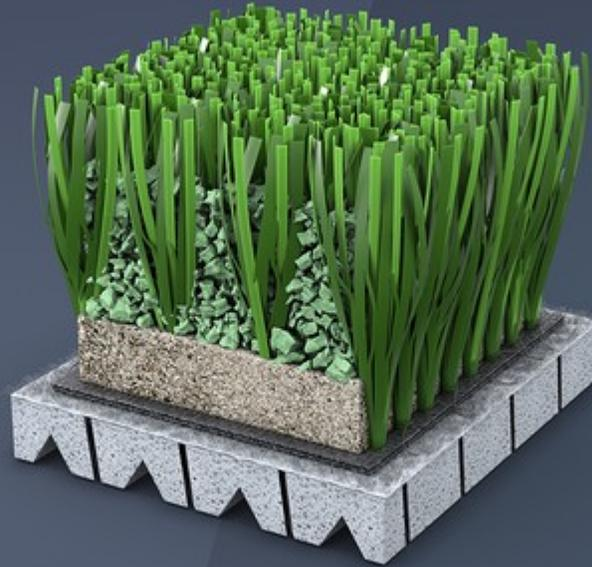
**SYSTÈME EN GAZON SYNTHÉTIQUE DE DERNIÈRE GÉNÉRATION COMPOSÉ D'UNE COMBINAISON DE MONOFILAMENTS 5NX À STRUCTURE DROITE SEMI-CONCAVE AVEC 3 NERVURES ASYMÉTRIQUES ET FILAMENTS FIBRILLÉS MONOFEEL, REMPLISSAGE DE PERFORMANCE EN GRANULAT DE SBR ENCAPSULÉ ET SOUS-COUCHE ÉLASTIQUE PRÉFABRIQUÉ EN MOUSSE DE POLYOLÉFINE RÉTICULÉE.**
