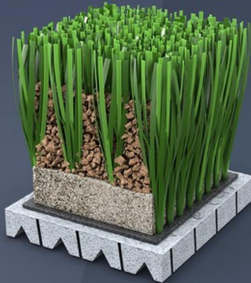
**SYSTÈME EN GAZON SYNTHÉTIQUE DE DERNIÈRE GÉNÉRATION COMPOSÉ D'UNE COMBINAISON DE MONOFILAMENTS 4NX À STRUCTURE DROITE SEMI-CONCAVE AVEC 3 NERVURES ASYMÉTRIQUES ET FILAMENTS FIBRILLÉS MONOFEEL, REMPLISSAGE DE PERFORMANCE EN LIÈGE CORK 120 ET SOUS-COUCHE ÉLASTIQUE PRÉFABRIQUÉ EN MOUSSE DE POLYOLÉFINE RÉTICULÉE.**
