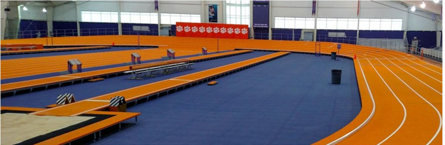
**NEL 1980, MONDO HA INSTALLATO LA PRIMA PISTA MODULTRACK SOPRAELEVATA PERMANENTE PRESSO IL PALAZZO A VELA DI TORINO. LE PISTE PERMANENTI MODULTRACK SONO TOTALMENTE A INNESTO PER GARANTIRNE LA FACILITÀ DI MONTAGGIO, DI TRASPORTO E L'ACCURATEZZA DIMENSIONALE NEL TEMPO. A DIFFERENZA DELLE SOLUZIONI PERMANENTI IN CEMENTO QUESTE PISTE POSSONO ESSERE MONTATE IN POCHI GIORNI, SENZA NECESSITÀ DI ATTENDERE I TEMPI DI ASCIUGATURA DEL MASSETTO.**
