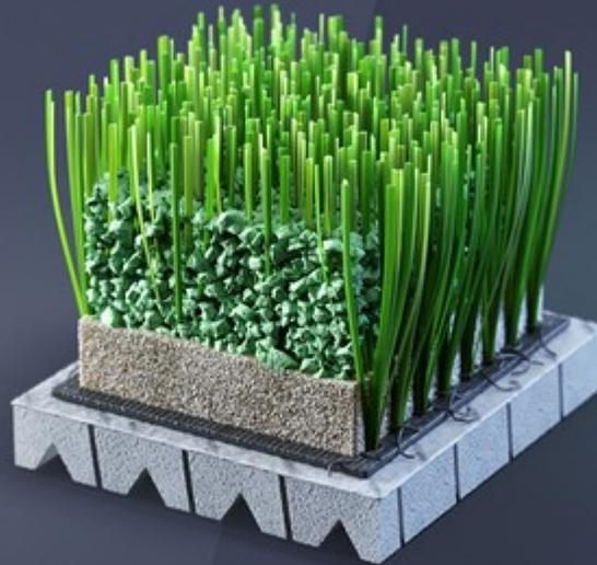
**SISTEMA DE CÉSPED ARTIFICIAL DE ÚLTIMA GENERACIÓN COMPUESTO POR MONOFILAMENTOS 5NX DE ESTRUCTURA RECTA SEMICÓNCAVA CON 3 NERVIOS ASIMÉTRICOS, RELLENO TÉCNICO ECOFILL® REBOUND Y SUBCAPA ELÁSTICA PREFABRICADA EN ESPUMA DE POLIOLEFINA RETICULADA.**
