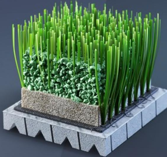
**SISTEMA IN ERBA ARTIFICIALE DI ULTIMA GENERAZIONE COMPOSTO DA MONOFILAMENTI 5NX A STRUTTURA DRITTA E SEZIONE SEMICONCAVA CON 3 NERVATURE ASIMMETRICHE E INTASO PRESTAZIONALE IN GRANULI DI SBR NOBILITATO E SOTTOTAPPETO ELASTICO PREFABBRICATO IN SCHIUMA POLIOLEFINICA RETICOLATA.**
