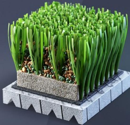
**SISTEMA IN ERBA ARTIFICIALE DI ULTIMA GENERAZIONE COMPOSTO DA UNA COMBINAZIONE DI MONOFILAMENTI 4NX A STRUTTURA DRITTA E SEZIONE SEMICONCAVA CON 3 NERVATURE ASIMMETRICHE E FILAMENTI FIBRILLATI MONOFEEL, INTASO PRESTAZIONALE NATURAL MIX® E SOTTOTAPPETO ELASTICO PREFABBRICATO IN SCHIUMA POLIOLEFINICA RETICOLATA.**
