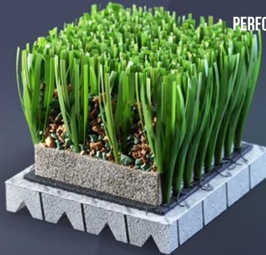
**SYSTÈME EN GAZON SYNTHÉTIQUE DE DERNIÈRE GÉNÉRATION COMPOSÉ D'UNE COMBINAISON DE MONOFILAMENTS 4NX À STRUCTURE DROITE SEMI-CONCAVE AVEC 3 NERVURES ASYMÉTRIQUES ET FILAMENTS FIBRILLÉS MONOFEEL, REMPLISSAGE DE PERFORMANCE NATURAL MIX® ET SOUS-COUCHE ÉLASTIQUE PRÉFABRIQUÉ EN MOUSSE DE POLYOLÉFINE RÉTICULÉE.**
