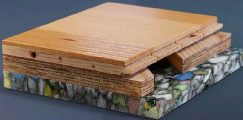
**ZETA SYSTEM ES UN SISTEMA DE PAVIMENTO DEPORTIVO TIPO ÁREA-ELÁSTICO CERTIFICADO FIBA NIVEL 1, COMPUESTO POR UNA SOLA CAPA DE CONTRACHAPADO FENÓLICO CORTADA EN PANELES Y FIJADO A UN PAVIMENTO DE MADERA TRATADO CON UN BARNIZ DE ALTA RESISTENCIA. EL SISTEMA ESTÁ AMORTIGUADO POR UNA CAPA DE ESPUMA FLEXIBLE DE POLIURETANO QUE SE SUMINISTRA EN PLACAS.**
