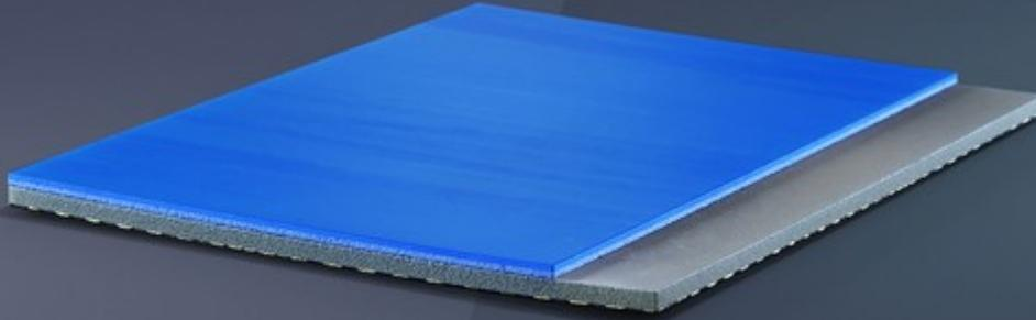
**SYSTÈME À DÉFORMATION PONCTUELLE QUI ASSOCIE LE REVÊTEMENT EN CAOUTCHOUC MONDOFLEX À LA SOUS-COUCHE AMORTISSANTE EVERLAY PROTECTION. LE SYSTÈME PEUT ÊTRE INSTALLÉ EN POSE LIBRE ET GARANTIT DES VALEURS D'ABSORPTION DE CHOCS COMPRIS ENTRE 25 % ET 34 % (CATÉGORIE P1 SELON LA NORME EN 14904), EN ASSURANT LE CONFORT ET LA SÉCURITÉ DES ATHLÈTES.**
