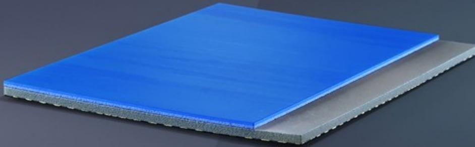
EN ESTE SISTEMA SE UNEN EL PAVIMENTO DE CAUCHO MONDOFLEX CON LA LÁMINA EVERLAY® PROTECTION, UNA SUBBASE ELÁSTICA ESTABILIZANTE QUE DOTA AL CONJUNTO DE UN EXCELENTE COMPORTAMIENTO DEPORTIVO. LA LÁMINA SE COLOCA FLOTANTE EN LA SOLERA Y GARANTIZA VALORES DE ABSORCIÓN DE IMPACTOS ENTRE UN 25% Y UN 34% (CATEGORÍA P1 SEGÚN LA NORMA EN 14904), POR LO QUE EL CONFORT Y LA SEGURIDAD DE LOS DEPORTISTAS ESTÁ GARANTIZADA.
