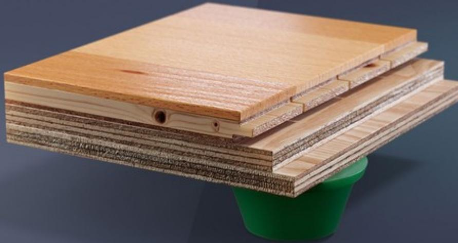
**MONDOELASTIC È UNA PAVIMENTAZIONE AREA ELASTIC IN LEGNO, OMOLOGATA FIBA LEVEL 1, COMPOSTA DA DUE STRATI DI COMPENSATO FENOLICO SU CUI VIENE FISSATA UNA FINITURA IN LEGNO PREFINITO E PRE-VERNICIATO CON VERNICE AD ALTA RESISTENZA. IL SISTEMA È CARATTERIZZATO NELLA PARTE INFERIORE DA SPECIALI SUPPORTI, AIR CELL® PADS, CHE ASSICURANO UNA PERFETTA OMOGENEITÀ DI RISPOSTA ELASTICA DELLA PAVIMENTAZIONE.**
