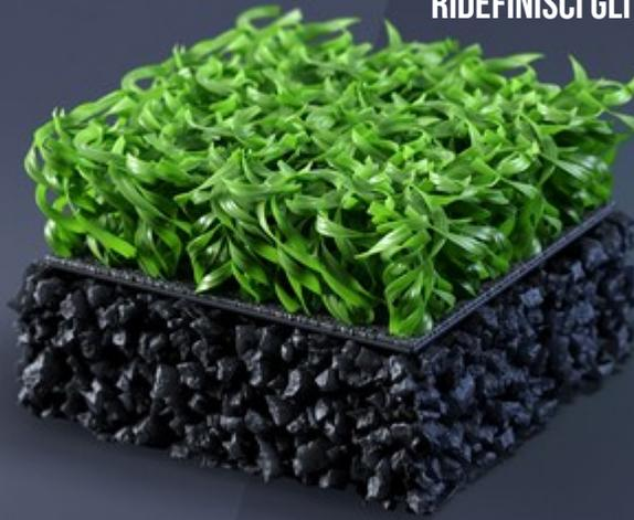
**SISTEMA IN ERBA ARTIFICIALE DI ULTIMA GENERAZIONE COMPOSTO DA MONOFILAMENTI 4NX TEXTURIZED, A STRUTTURA DRITTA SEMICONCAVA CON 3 NERVATURE ASIMMETRICHE, TESTURIZZATI, SOTTOTAPPETO ELASTICO IN GRANULATO DI SBR REALIZZATO IN SITU. IL SISTEMA È PRIVO DI INTASO E PUÒ ESSERE UTILIZZATO COME CAMPO AD ACQUA.**
