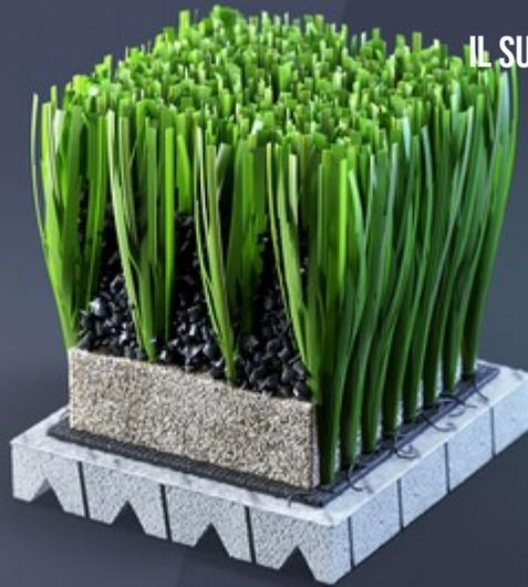
**SISTEMA IN ERBA ARTIFICIALE DI ULTIMA GENERAZIONE COMPOSTO DA UNA COMBINAZIONE DI MONOFILAMENTI 5NX A STRUTTURA DRITTA SEMICONCAVA CON 3 NERVATURE ASIMMETRICHE E FILAMENTI FIBRILLATI MONOFEEL, INTASO PRESTAZIONALE IN SBR O SBR NOBILITATO E SOTTOTAPPETO ELASTICO PREFABBRICATO IN SCHIUMA POLIOLEFINICA RETICOLATA.**
