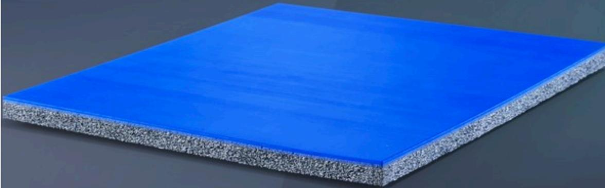
**MONDOFLEX II È UN PAVIMENTO SPORTIVO POINT ELASTIC CON VALORI DI ASSORBIMENTO DEGLI URTI SUPERIORI AL 25% (CATEGORIA P1 SECONDO LA NORMATIVA EN 14904). IL PAVIMENTO È COMPOSTO DA DUE STRATI DI GOMMA NATURALE E SINTETICA ACCOPPIATI IN FASE DI PRODUZIONE A UN SOTTOSTRATO PORTANTE ELASTICO ESPANSO. LA PREFABBRICAZIONE GARANTISCE L'UNIFORMITÀ DEL PRODOTTO UNA VOLTA POSATO E UNA RISPOSTA BIOMECCANICA COSTANTE SU TUTTA LA SUPERFICIE.**
