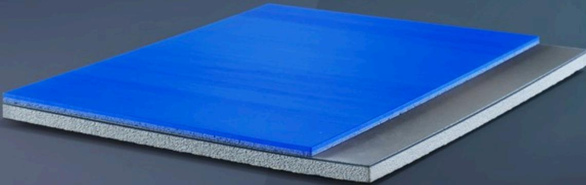
EN ESTE SISTEMA SE UNEN EL PAVIMENTO DE CAUCHO MONDOFLEX CON LA LÁMINA EVERLAY® HIGH PROTECTION, UNA SUBBASE ELÁSTICA ESTABILIZANTE QUE DOTA AL CONJUNTO DE UN EXCELENTE COMPORTAMIENTO DEPORTIVO. LA LÁMINA SE COLOCA FLOTANTE EN LA SOLERA Y GARANTIZA VALORES DE ABSORCIÓN DE IMPACTOS ENTRE UN 35% Y UN 44% (CATEGORÍA P2 SEGÚN LA NORMA EN 14904), POR LO QUE EL CONFORT Y LA SEGURIDAD DE LOS DEPORTISTAS ESTÁ GARANTIZADA.
