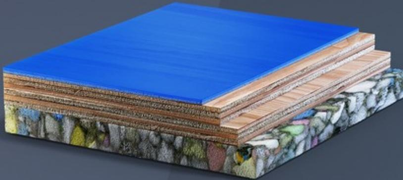
**PREMIERPLUS MONDOFLEX EST UN SYSTÈME EN BOIS AREA ELASTIC, FIXE, AVEC FINITION SUPERFICIELLE EN CAOUTCHOUC. LE SYSTÈME GARANTIT DES VALEURS DE RETOUR D'ÉNERGIE SUPÉRIEURES À 50 % GRÂCE À LA COUCHE DE SOUPLESSE EN POLYURÉTHANE EXPANSÉ FLEXIBLE SUR LAQUELLE EST INSTALLÉE LA COMBINAISON DES DEUX COUCHES DE CONTREPLAQUÉ PHÉNOLIQUE ET LA FINITION MONDOFLEX.**
